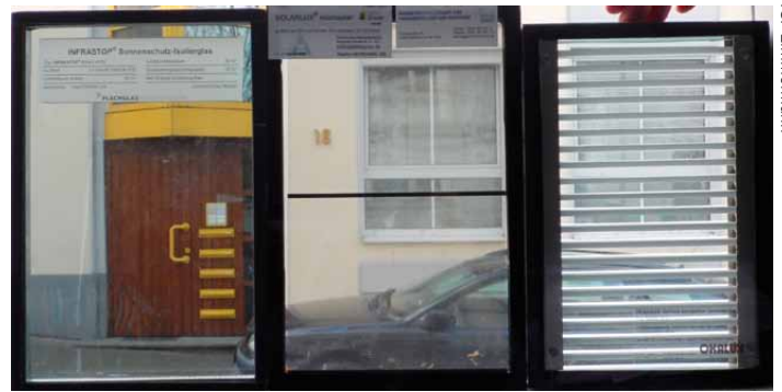
Sonnenschutzverglasung (links), Verglasung mit MicroShade (mitte), Verglasung mit Lichtumlenkung Okalux (rechts)
