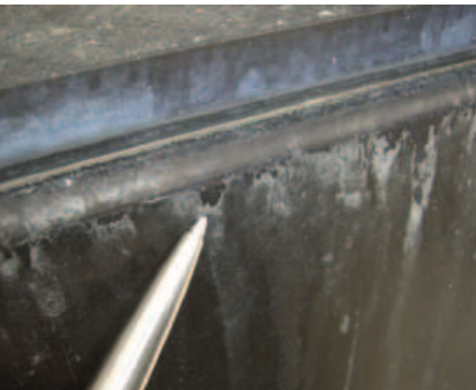
Bild 2: Beginnende Lackabplatzungen des aufgetragenen Klarlackes auf einer bewitterten, eloxierten Oberfläche.
