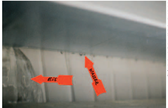
Bild 11: Durch Ansteigen der Oberflächentemperatur bilden sich Wassertropfen.
