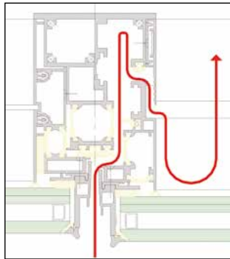
Parallelausstellfenster nach außen mit „Kinder“-Ausstellweite 89 mm und Labyrinth mit schalldämpfendem Material.
