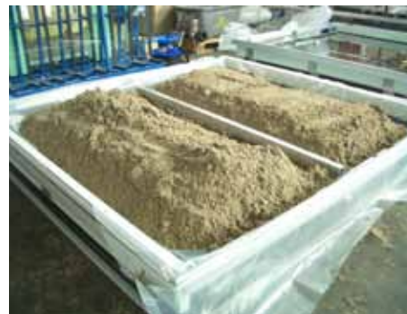
Versuche zur Belastbarkeit der Scheiben mit Sand.
