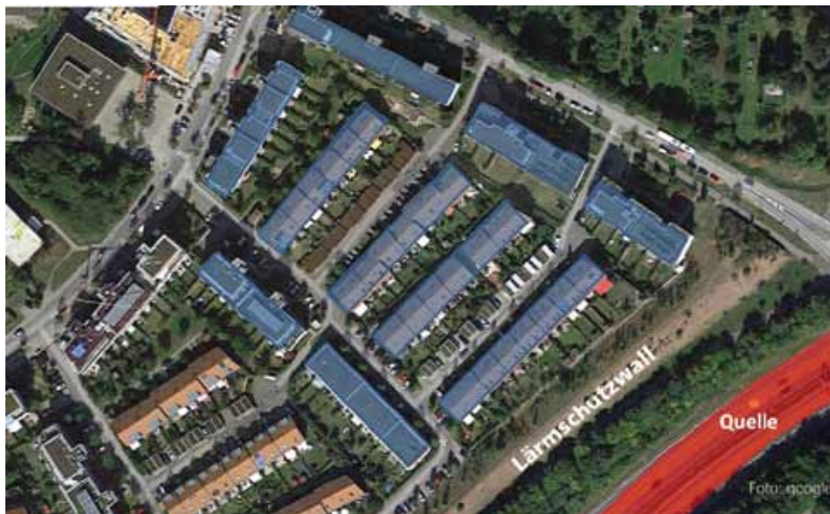
Abb. 1: Gebäudeensemble (blau markiert) in unmittelbarer Nähe zu einer Autobahn als Lärmquelle (rot markiert) mit dazwischen liegendem, bewachsenem Lärmschutzwall.
