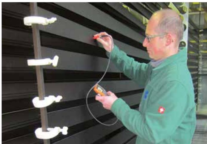
Kontrolle der Schichtdicke der Eloxalschicht an der Warenschiene kurz nach dem Eloxieren.
