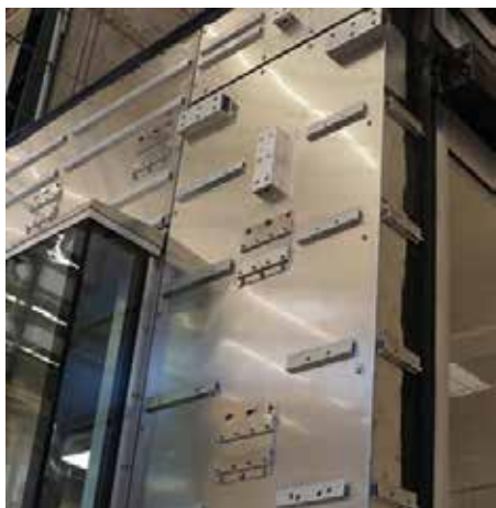
Teilansicht einer mehrteiligen Prüfmuster-Elementkombination.
