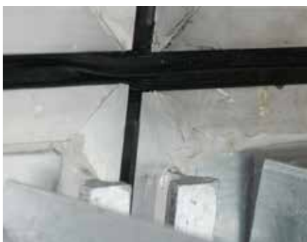
Test eines verschobenen Elementfugen-Kreuzpunktes.
