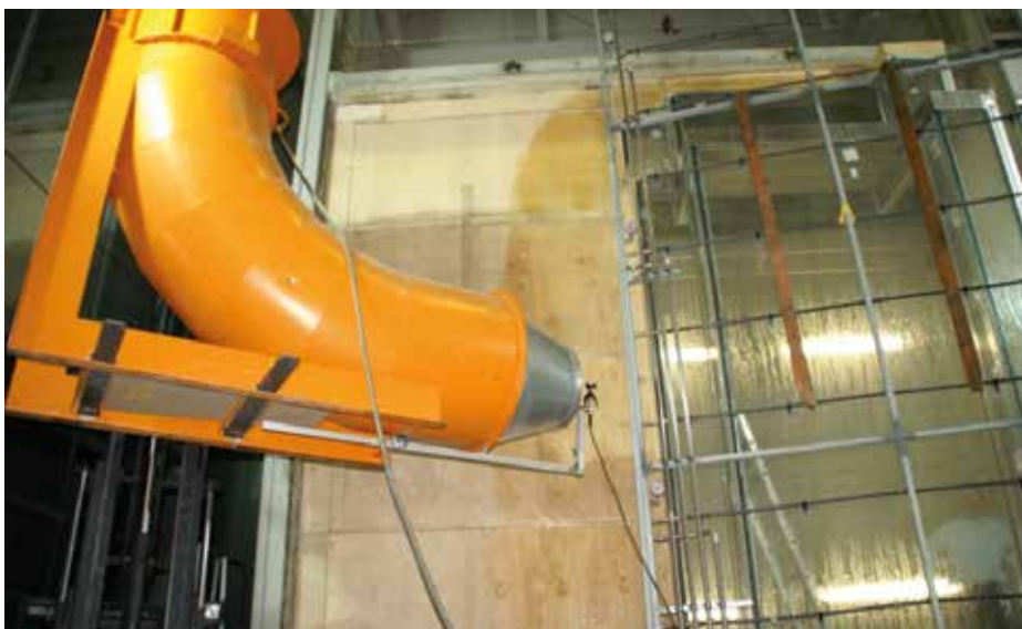
Aufbringen maximaler lokaler Windlast kombiniert mit Bewegung.
