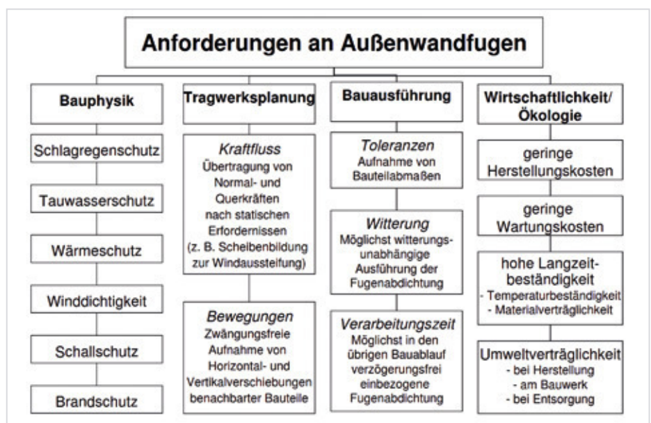
Bild 2: Anforderungen an Außenwandfugen.
